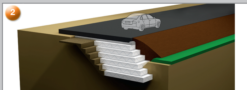
Løsning til sideudvidelse af vejdamning hen over blødbundsområde eller svag konstruktion (pæledæk).
